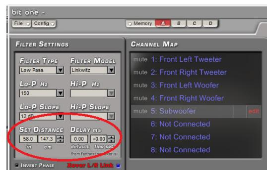
2. Если в поле данных **Unit** (Единицы измерения) выбрать миллисекунды (ms), bit Tune покажет измеренное время прихода звуковой волны от центра каждого динамика до измерительного микрофона. Чем дальше динамик (например сабвуфер), тем больше время распространения звуковой волны до микрофона, и наоборот: чем ближе динамик (например, левый передний ВЧ-динамик) тем меньше время.
