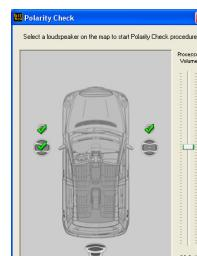
– Красный значок означает, что динамик включен неправильно, т.е. в противофазе к правильной полярности. Измените полярность включения динамика, поменяв местами разъемы «+» и «-» в терминалах динамика или кроссовера, затем выполните повторную проверку.
